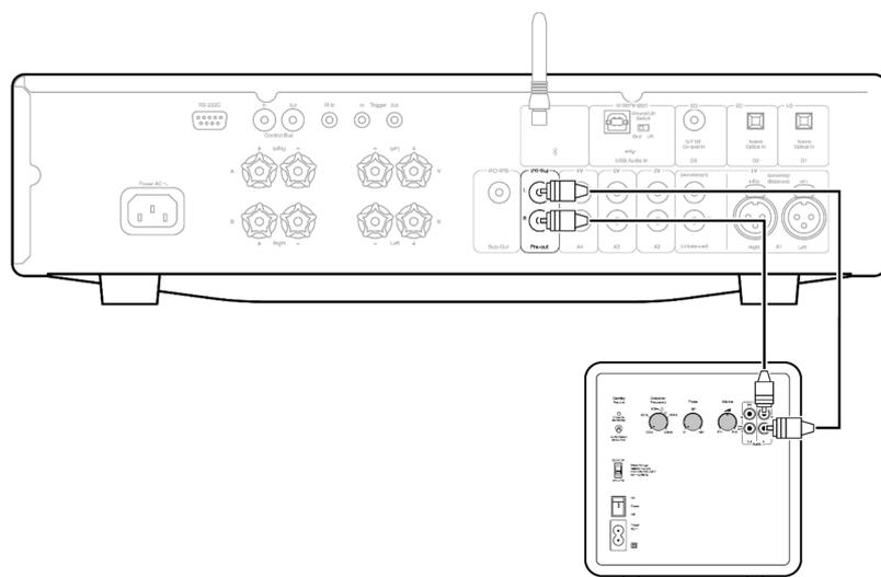
2. Falls Sie einen Receiver oder Verstärker mit einem gesonderten Subwoofer-Ausgang verwenden, schließen Sie diesen über den Eingang für den linken Kanal (LFE/Sub) an den Minx X201 an.
