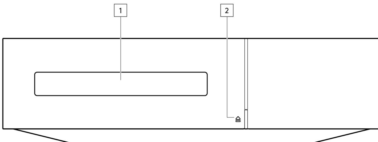
1. **Disc-Schublade** - Zum Einlegen von Compact Discs; wird mit der Taste „Open/Close“ bedient.
