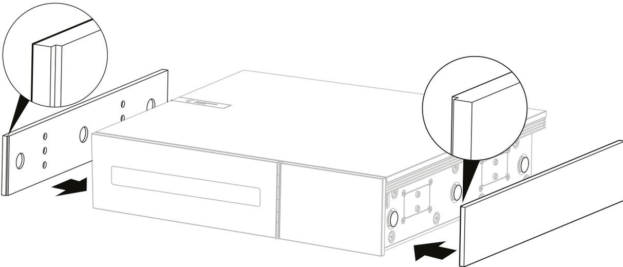
Achten Sie beim Anbringen neuer Magnetseitenteile darauf, dass die Rillen an der Richtung der Frontblende ausgerichtet sind. Setzen Sie sie von hinten ein, wobei Sie die Rückseite der Verkleidung festhalten.
