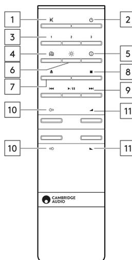
Sollte die Fernbedienung nicht funktionieren, vergewissern Sie sich bitte, dass die Batterien nicht leer sind und dass der IR-Empfänger am EVO 75 / 150 nicht verdeckt ist. Der EVO CD selbst verfügt über keinen IR-Empfänger.
