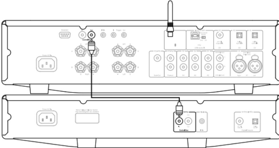
**Nota:** El CXC y el CXA cuentan con una función de Apagado Automático (APD). Si la función APD está activada y uno de los dispositivos está encendido pero inactivo, el dispositivo se apagará automáticamente después de la hora seleccionada en la APD. Esto apagará todos los demás dispositivos conectados, debido a la conexión del Bus de Control.
