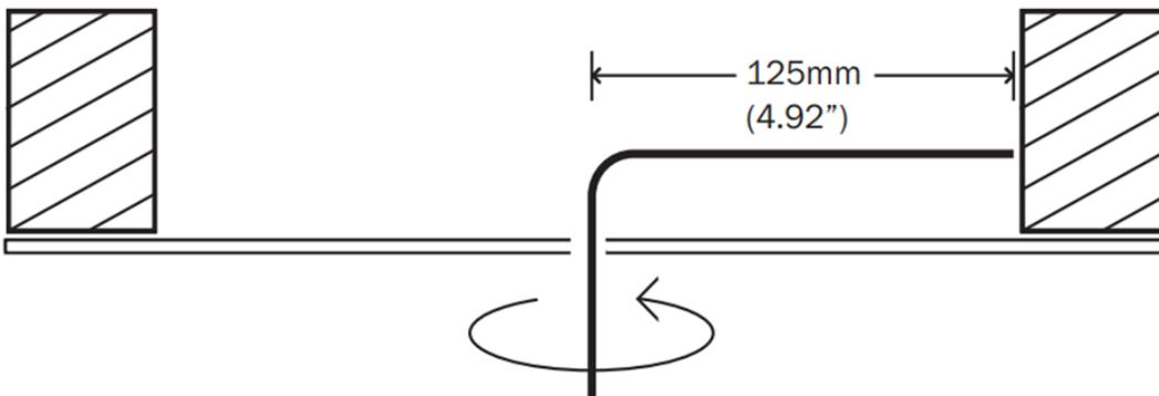
3. Recorta el agujero de montaje con un cartón yeso o una sierra de punta. Asegúrate de que la superficie de montaje tenga entre 10 y 30 mm (0,39 - 1,18") de espesor, y que haya al menos 93 mm (3,74") de espacio libre detrás de la superficie de montaje.
