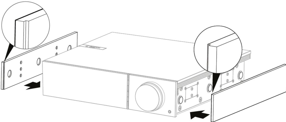
Lorsque vous installez de nouveaux panneaux latéraux magnétiques, veillez à ce que les découpes des rainures soient alignées avec l'orientation du panneau frontal. Insérez par l'arrière en tenant l'arrière du panneau.
