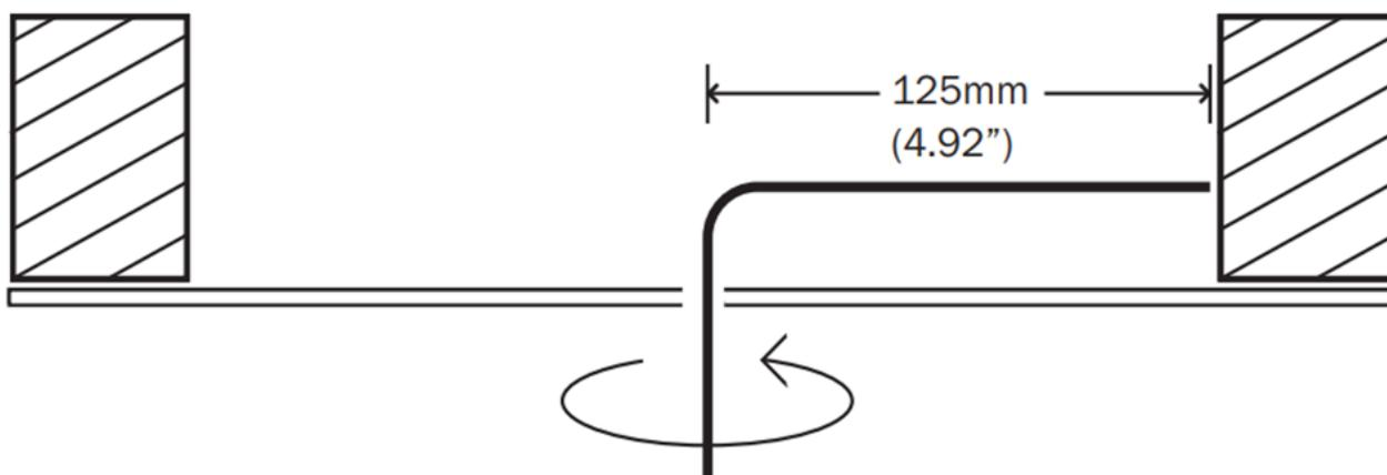
3. Tagliare il foro di montaggio con una seghetto per parete o da traforo. Accertarsi che la superficie di montaggio sia compresa tra 10 e 30 mm (0,39 - 1,18") di spessore, e che ci sia almeno 93 mm (3,74") di spazio dietro la superficie di montaggio.
