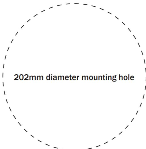
2. Prima del taglio dei fori del diffusore a soffitto, si consiglia di provare l'intercapedine facendo una sonda a forma di L dal filo forte (vedere illustrazione di seguito), praticando un piccolo foro nell'area di destinazione, inserire la sonda e girare lentamente. Eventuali ostruzioni saranno immediatamente evidenti, e sarà possibile spostare l'area di destinazione in una posizione più opportuna.
