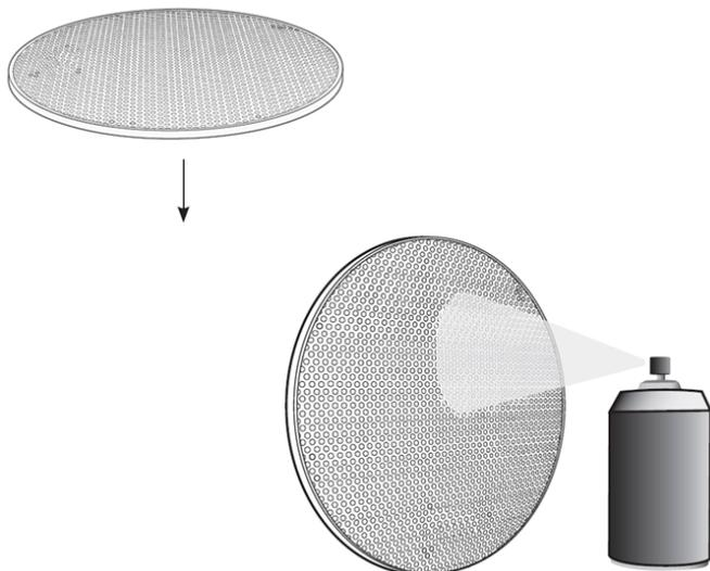
3. Se si desidera verniciare il contorno del diffusore, utilizzare la maschera di pittura in plastica trasparente inclusa per coprire il cono del diffusore ed evitare di causare danni.
