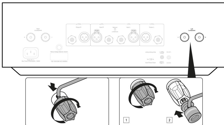
左チャンネルのラウドスピーカーから左のプラスとマイナスの端子に、そして右チャンネルのラウドスピーカーを右のプラスとマイナスの端子にそれぞれ接続します。
