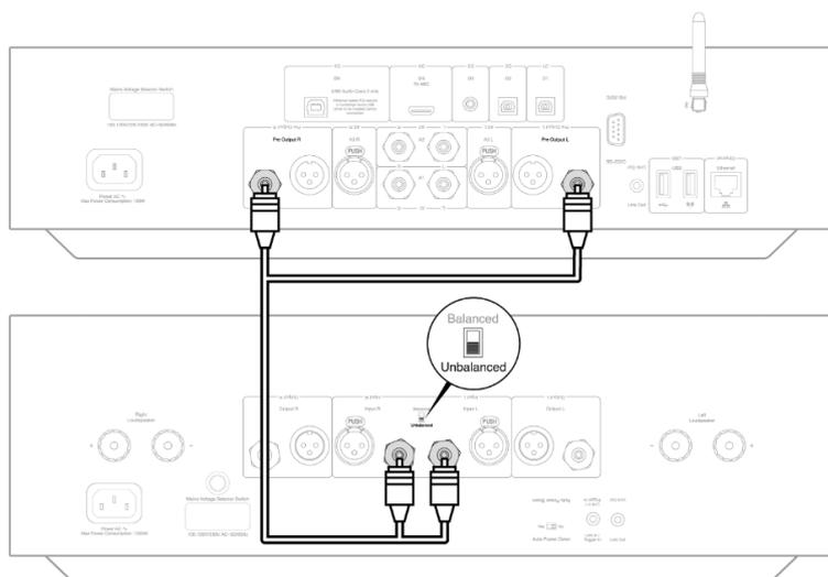
RCAケーブルを使用すると、EDGE Wへのアンバランスアナログ接続が可能になります。
