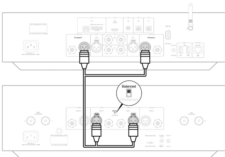
XLRケーブルを使用すると、EDGE Wとのアナログバランス接続が可能になります。RCAアンバランス接続に比べ、特にケーブル長が長い場合、よりクリーンな信号経路となりますが、短距離での使用における音質の向上は主観的なものです。
