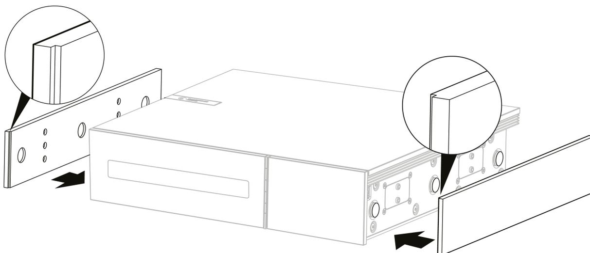
新しい磁器サイドパネルをインストールする際は溝がフロントパネルの方向に沿っていることを確認してください。パネルの後部を持ってリアを挿入してください。
