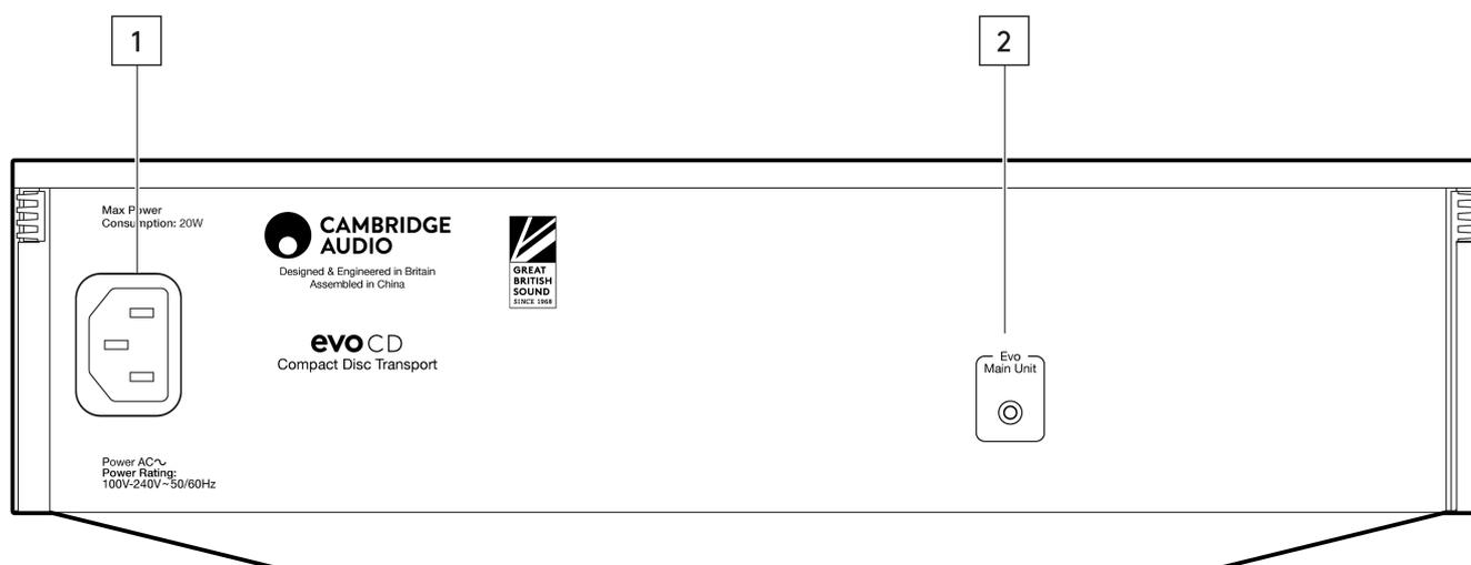
1.AC電源ソケット - EVO CDへの全ての接続が完了したら、AC電源ケーブルを適切な電源ソケットに差込、電源を入れます。これで、EVO CDを使用する準備が整いました。
