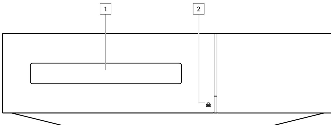
1. ディスクトレイ-開く/閉じるボタンで操作するコンパクトディスクのロードに使用されます。
