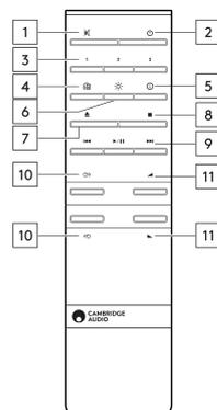
リモコンが機能しない場合は、電池の有効期限が切れていないこと、およびEVO 75/150にあるフロントパネルのIRレシーバーを遮るものが何もないことを確認してください。EVO CDにIRセンサーが配置されていない
